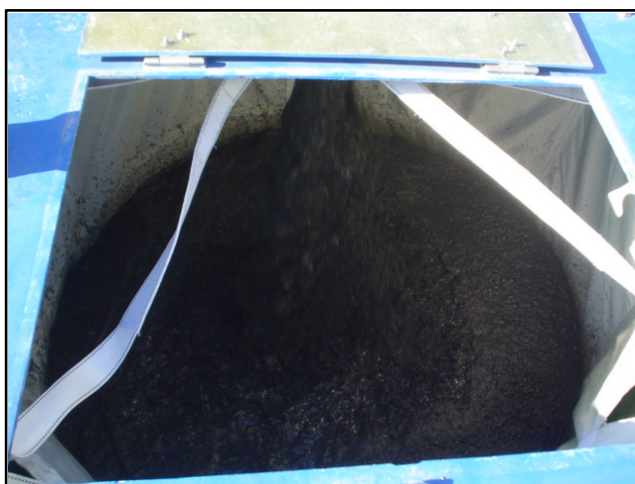
Photo : Sac filtrant rempli de boues de carénage toxiques.
